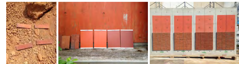
モックアップによる赤土色壁の確認
