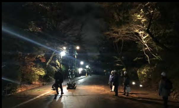
夜間照明のモックアップによる効果の確認
