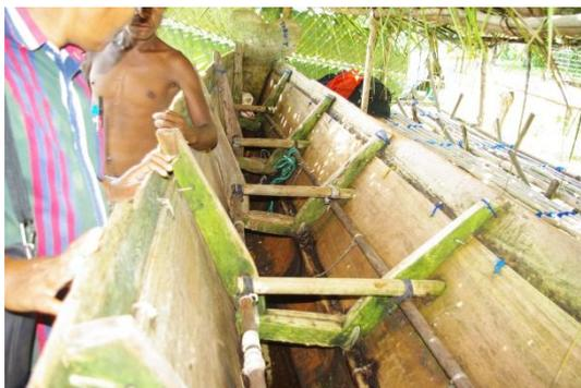
写真 30 : クラカヌーの内部構造
