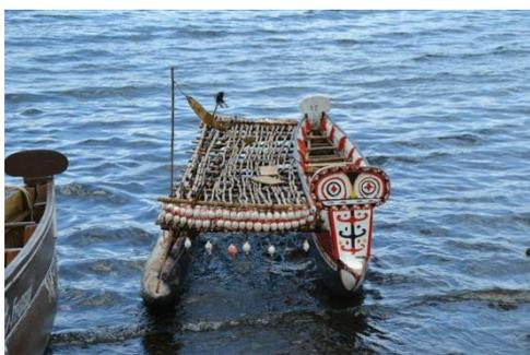
写真 21: 蔦で結縛されたクラ型カヌー(アロタウのカヌーフェスティバル; 2012年11月)
